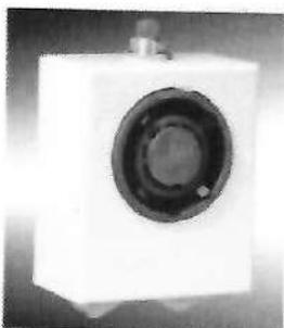
Ventouse sans contrôle de position, 24 Volts à rupture avec bouton poussoir pour porte coupe-feu. Livrée avec une contre-plaque articulée. Force de maintien 20 daN, puissance 0,6 W. Consommation 25 mA
