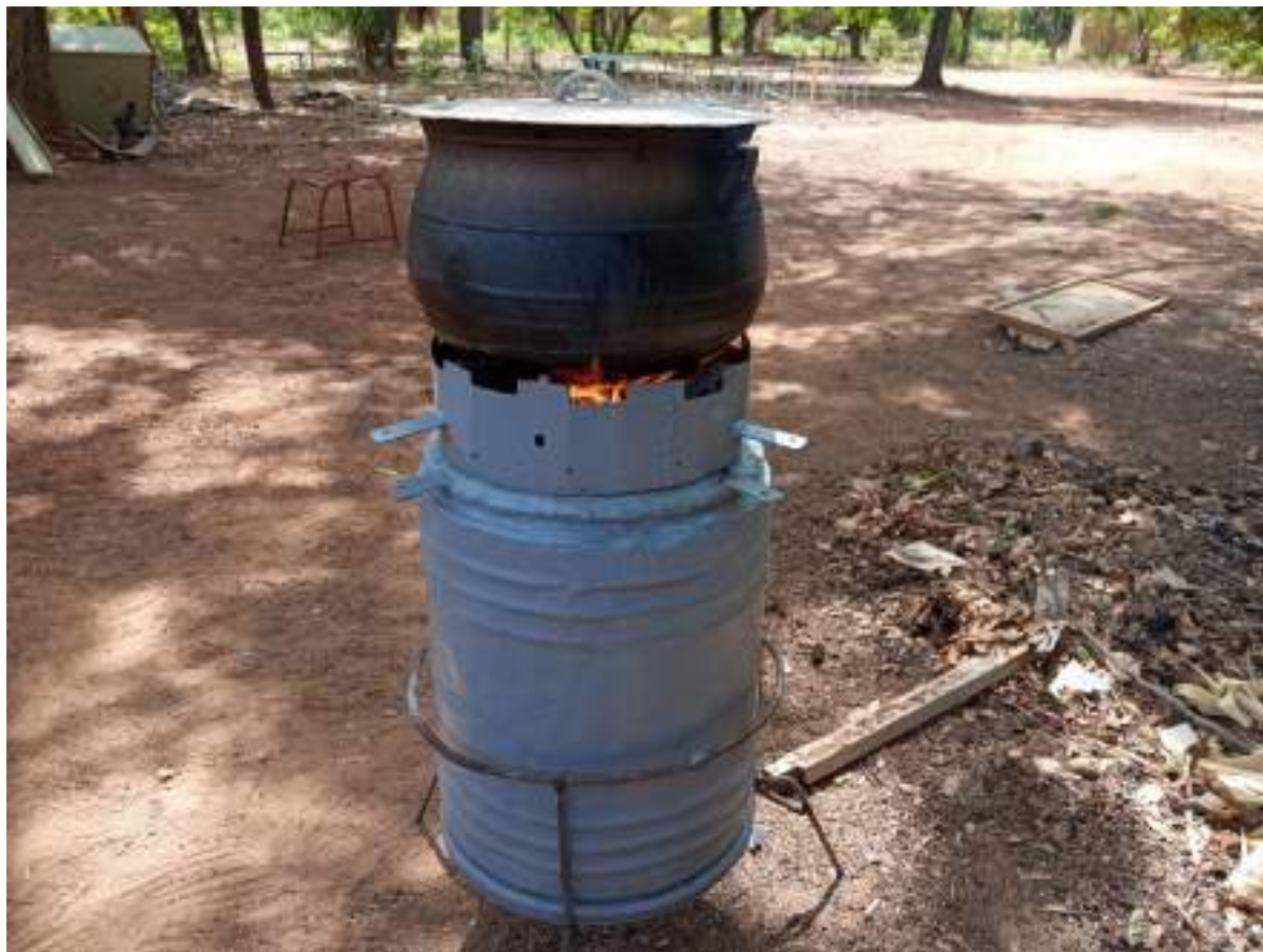
Four à pyrolyse (utilisé pour cuisson et production de biochar, brevet en cours) 6 .
